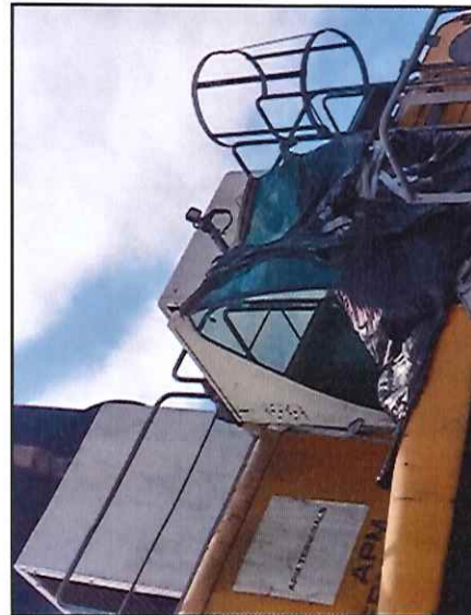
Local: Cabine Inferior Item # 58: cabine de operação inferior está com a estrutura avariada.
