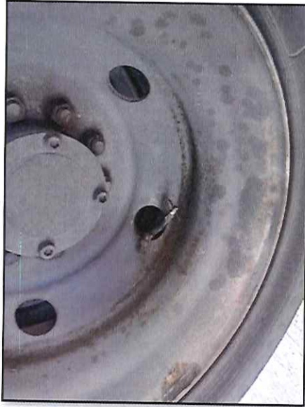
Local: Estrutura Rodante Item # 05: sinais de corrosão em alguns aros (rodas).
