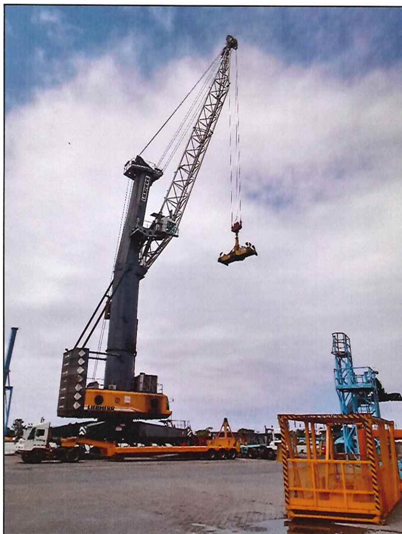
Figura 1. Guindaste de cais (Mobile Harbor Crane), MHC-02.
